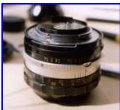
FIG. 10 - Crude AI modification
